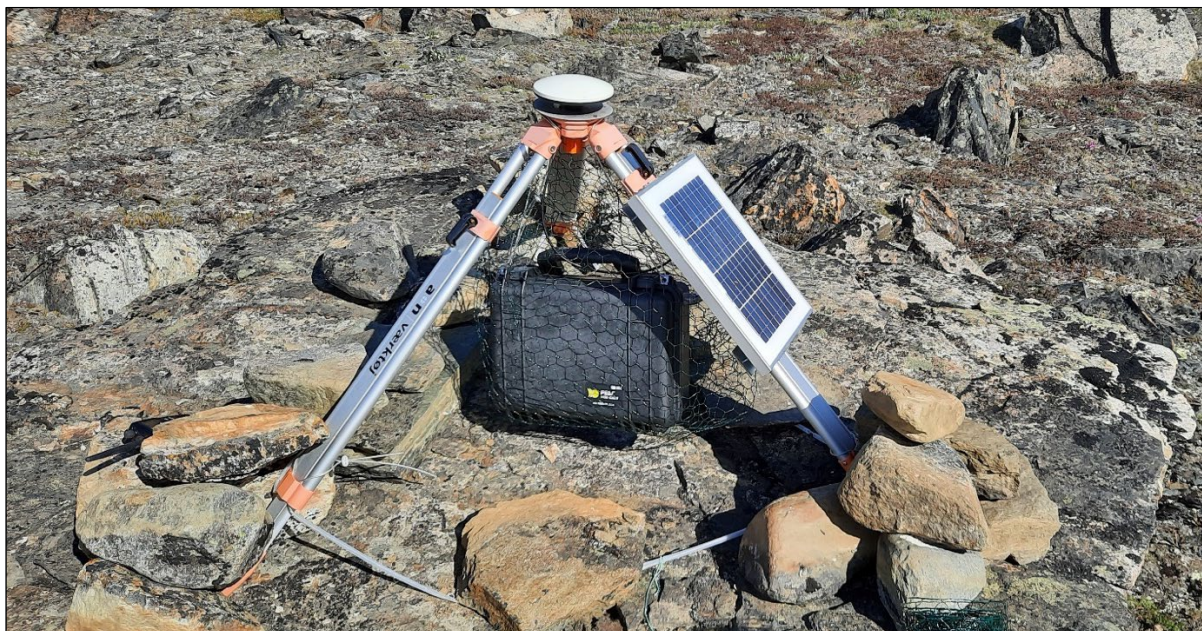
Figur 2: Foto af en af de specialudviklede GNSS-stationer, som er installeret i Karrat 3. Antennen er den hvide skive øverst på trefoden. GNSS-modtageren og batterier er i den sorte pelicase under trefoden. Trefodens ben er spændt ud med metalwire og tynget ned med sten for at øge stabiliteten.
